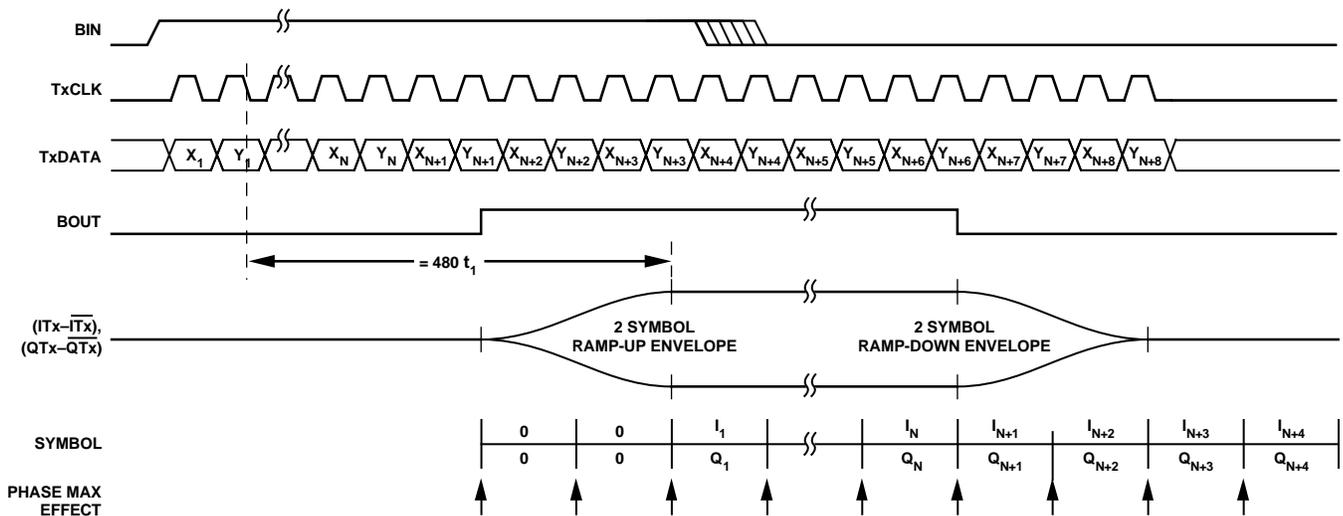
Figure 11. Transmit Burst
